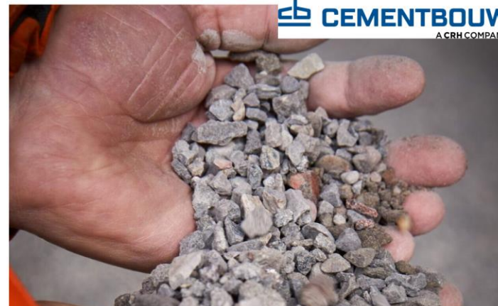
Permanente CO 2 -opslag in betongranulaat
